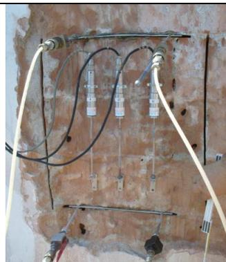
**Figura 32 - prova con martinetto piatto su muratura interna**
