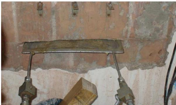
**Figura 31 - martinetto piatto**
