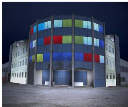
*2). Il progetto sviluppato e permesso grazie alla tecnologia LED rgb dinamica è composto da 64 apparecchi regolati da un unico software programmabile e definibile dall'utente rendendo di fatto infinite le possibilità di effetti. Tutto la commessa è stata svolta sulla base di simulazioni software e dinamiche al fine di esplicitare al meglio al cliente la filosofia dell'opera.*
